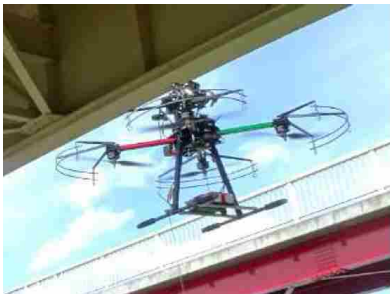
ドローンにより損傷写真を撮影
