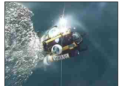
ダムの堤体や機械設備等の水中部の調査に活用
