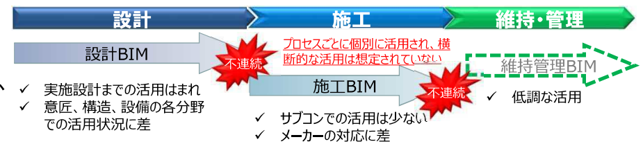
<各生産プロセスにおけるBIMモデル・情報の利用状況>
