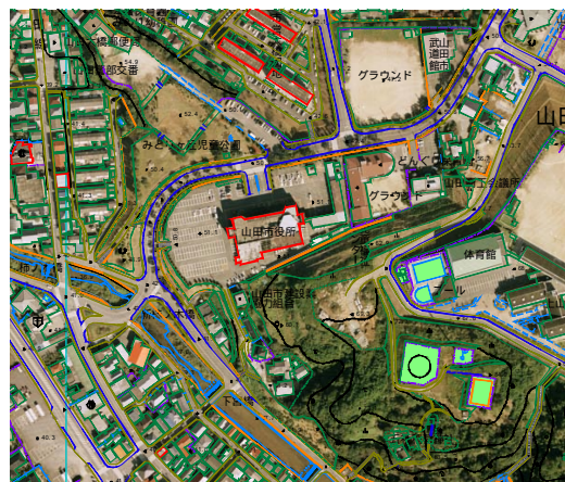
図3-1-2 DMデータとオルソフォトの重ね合わせ
