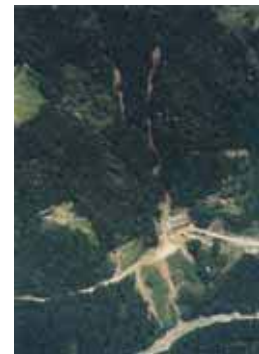
写真-1 とびのす谷下流部の土砂堆積状況（写真上部の左側が B 支溪の崩壊（No.3）、右側が C 支溪の崩壊（No.4））
