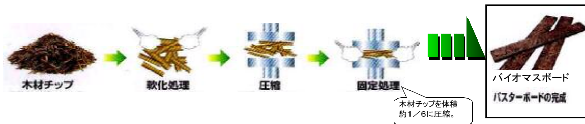
図-1 バイオマスボード製造工程
