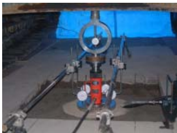
写真 - 2 平板載荷試験実施状況
