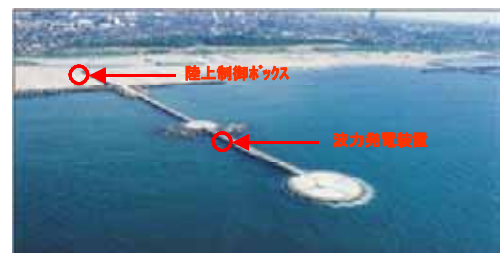
写真-2 実験装置全体配置
