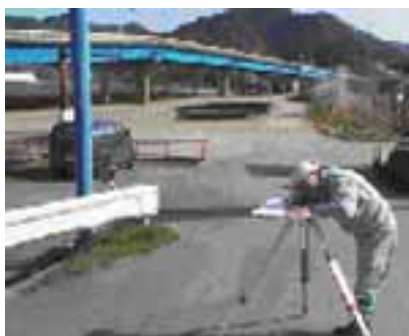
図4 平板測量による点検
