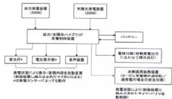
図-6 発電システム概要図
