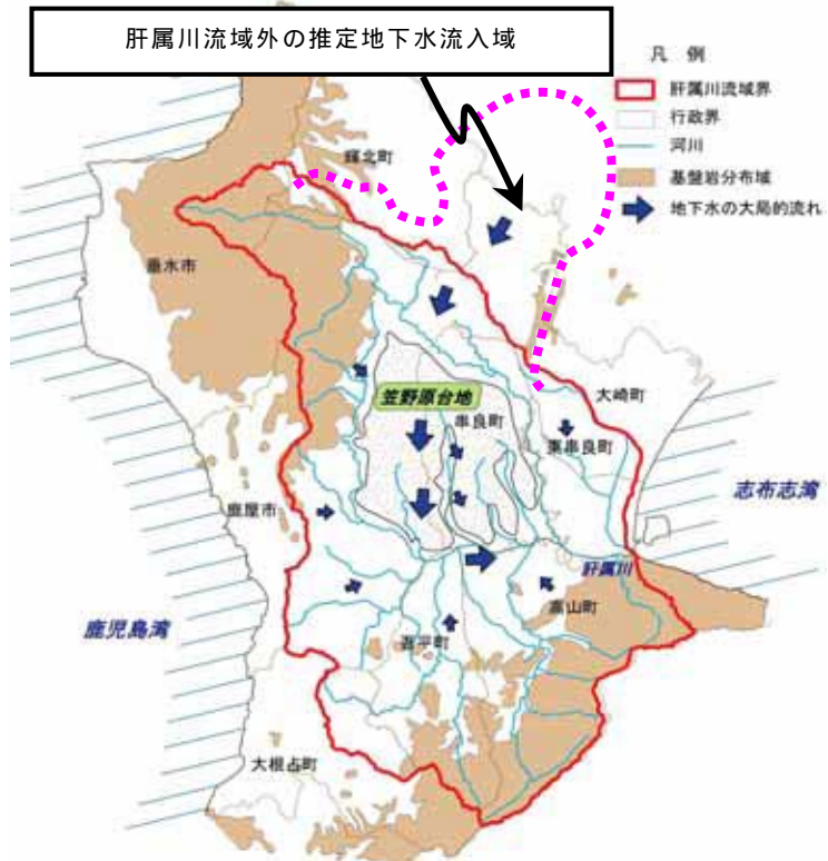
図 - 5 肝属川水系における地下水の平面的流れ
