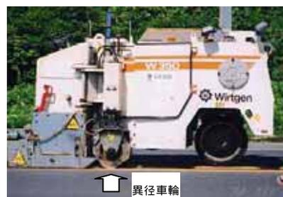
写真 1. 施工機械の異径車輪
