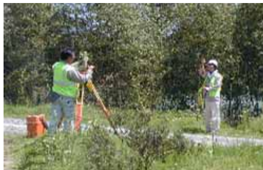
図5 水準測量による点検
