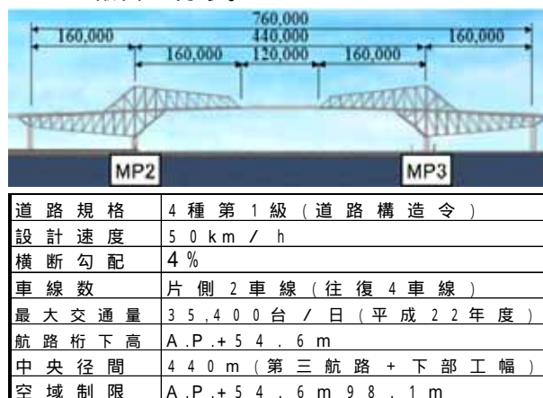
図-2 構造図および設計条件
