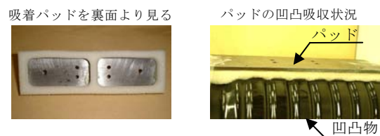
写真-2 吸着パッドと密着性状況
