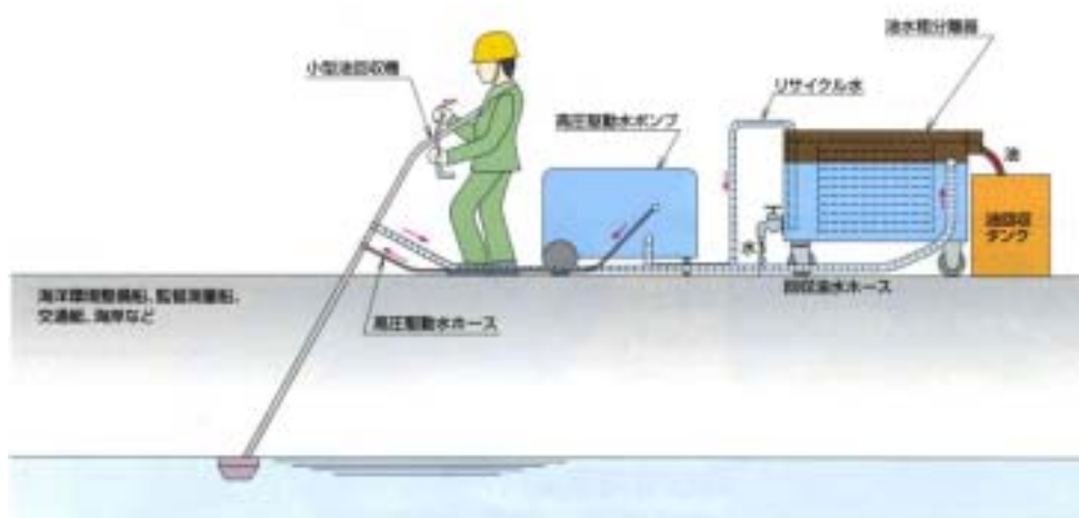
図 - 5 小型油回収機の作業イメージ
