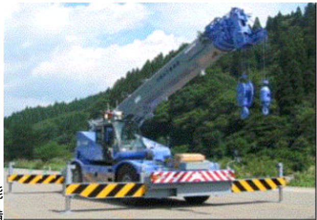
写真 - 1 無人ラフテレーンクレーン
