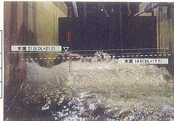
写真-1 打ち上げ高さ
