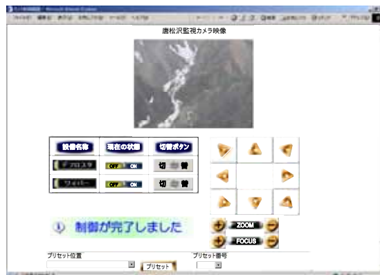
図5. 監視カメラ制御WEB画面
