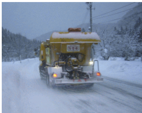
写真 4-1 凍結抑制剤散布状況
