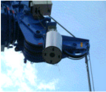
写真-3 クレーンカメラ
