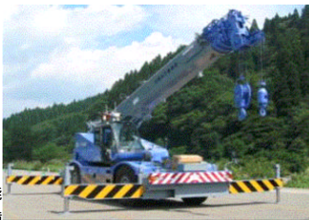
写真 - 1 無人ラフテレーンクレーン
