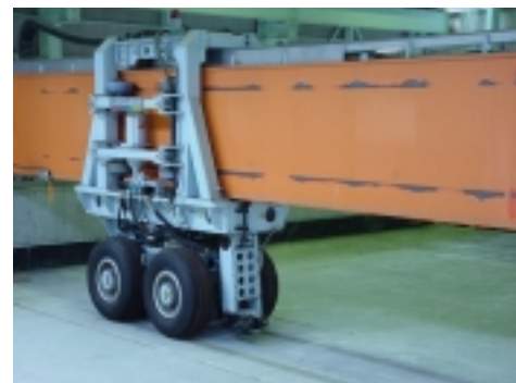
写真-5 自走式走行載荷試験装置
