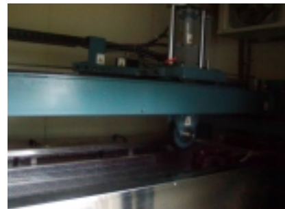
写真-4 ホイールトラッキング試験
