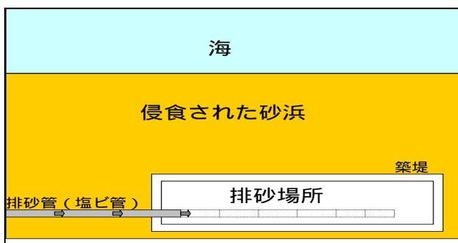
図-4 排砂場所平面図
