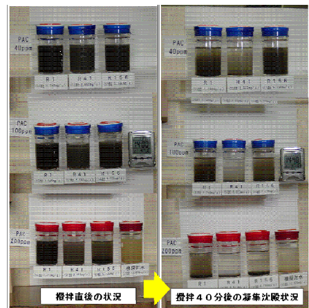
写真-2 凝集沈殿試験状況
