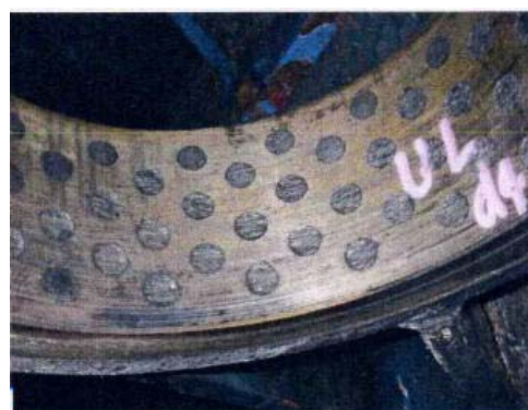
写真-7 偏心軸用軸受固体潤滑剤剥離状況
