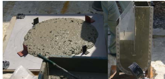
写真1 スランプフロー試験、間隙透過性試験
