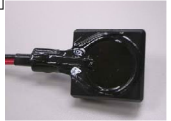
写真-2 上: 充填検知装置 下: センサー
