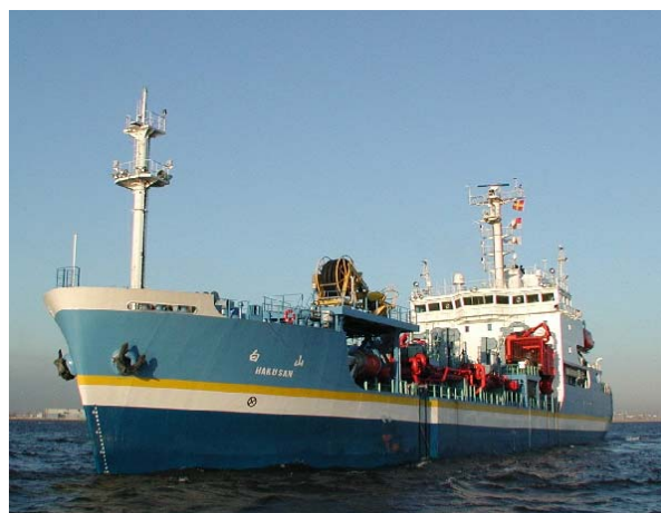
写真－1 大型浚渫兼油回収船「白山」
