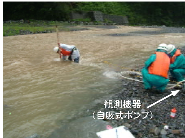
写真 - 3 搬入式観測機器の例（自吸式ポンプ）
