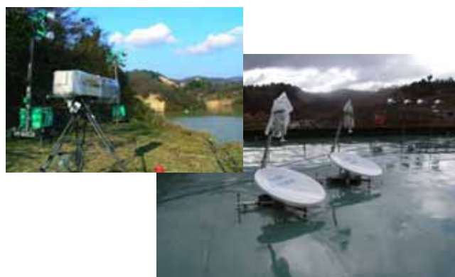
写真 3.8 カメラと Ku-SAT 設置状況
