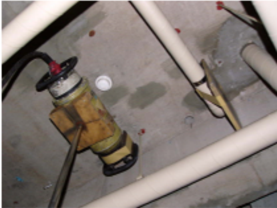
写真－3 X線発生器及びフィルム設置状況
