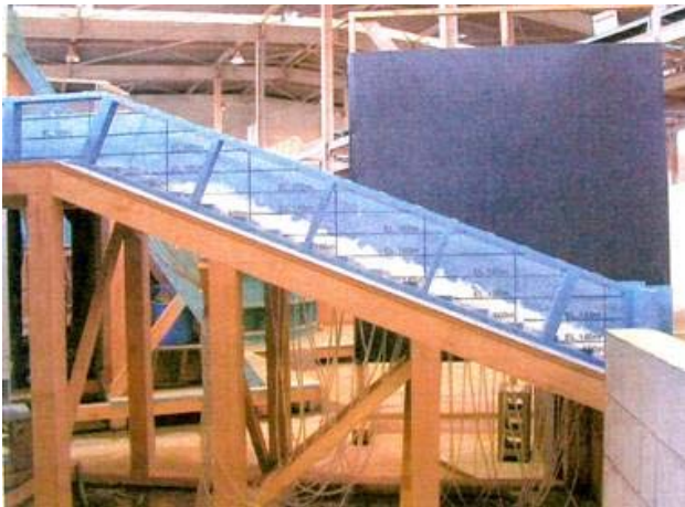
【写真-3】カスケード型減勢方式による減勢状況（計画最大放流量：模型実験）
