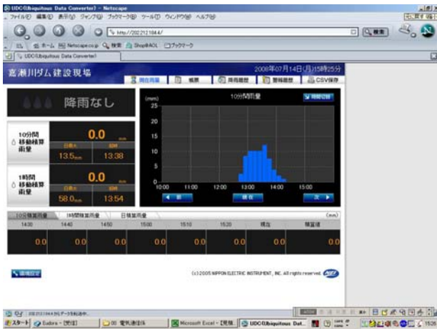
【写真12：現場雨量インターネット配信画面】
