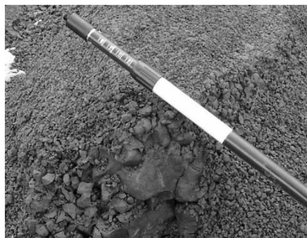
写真-3 自然状態でスレーキングした泥岩
