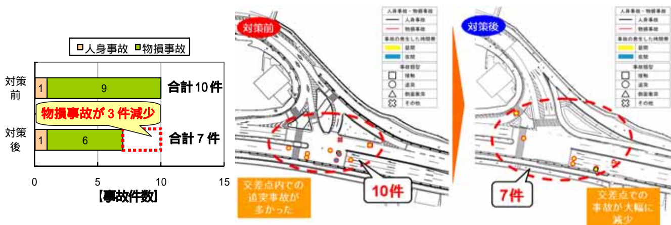
図-8 対策前後の事故発生状況の比較（交差点改良の前後6ヶ月のデータによる比較）
