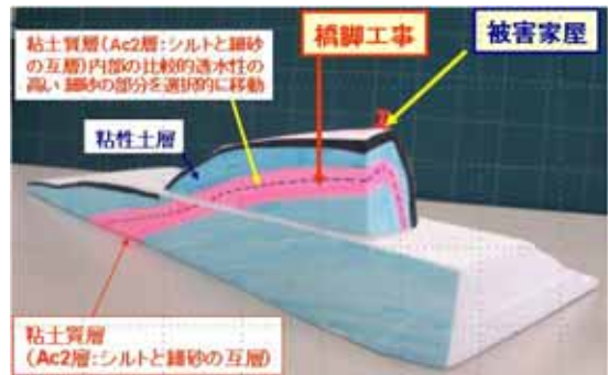
写真4.3.4 地層の傾斜：漏気は透水係数の高い地層に進入し、尾根を移動したと推察。
