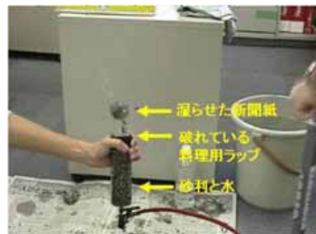
写真4.4.4 閉塞井戸の噴出：密閉した井戸に地下の空気が上昇・膨張した状況をモデル化。
