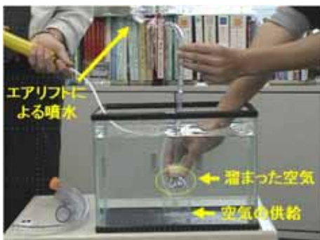
写真4.4.1 水の噴出：空気の上昇と、それに伴う膨張により発生する圧力をモデル化。
