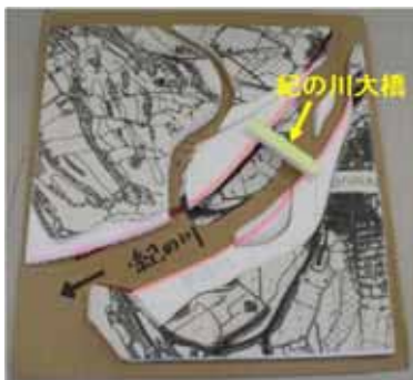
写真4.3.2 現在河道：紀の川の改修により中洲の一部を撤去。河道となった。
