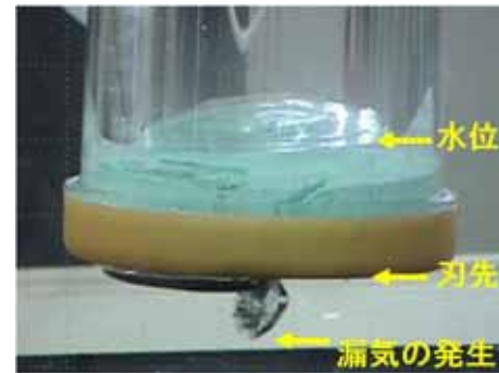
写真4.2.5 模型による漏気発生
