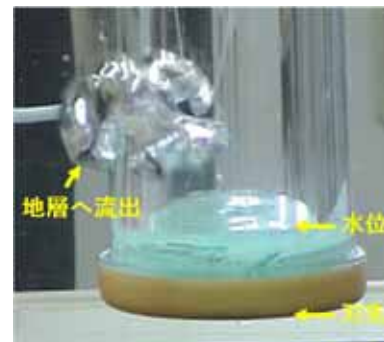
写真4.2.6 模型による地中への漏気再現
