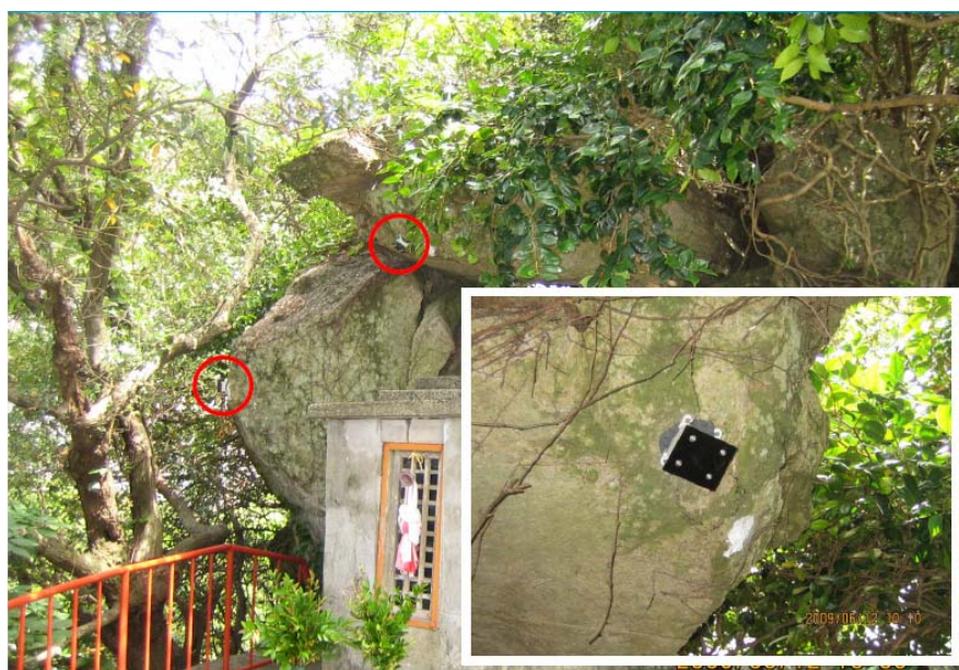
図-9 無線センサ設置例（丸内）
