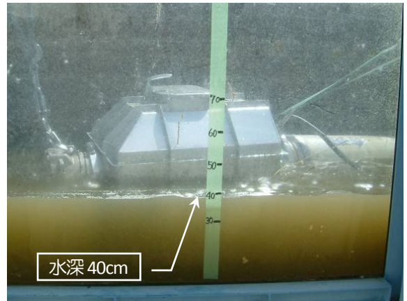
写真-5 水深 40cm での運転状況
