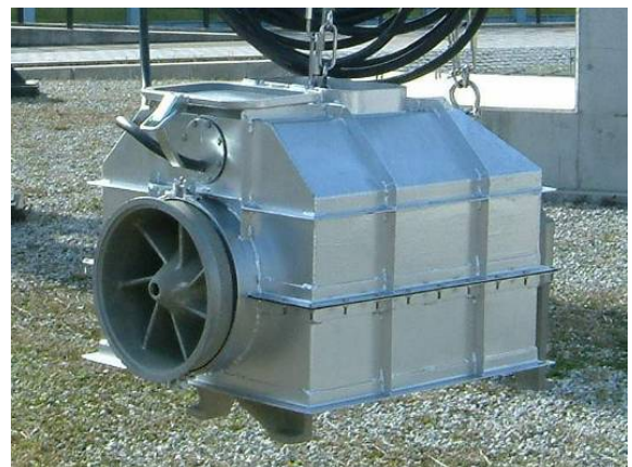
写真-4 排水ポンプ(改良後)
