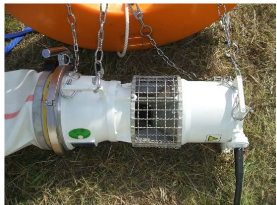
写真-6 軽量型排水ポンプ（5m 3 /min タイプ）
