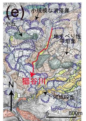
図-3 (a) 2009年6月14日~2009年7月30日のSAR干渉画像（北行軌道、オフナディア角 34.3°, Bperp = -175m）、(b) 「(a)」の志津温泉地区の拡大図、(c) 「(a)」の七五三掛地区の拡大図、(d) 「(b)」の干渉性を画像化した図、(e) 七五三掛地区の微地形分類図、基図は新庄河川事務所 1/5,000「赤川流域平面図（梵字川）」。
