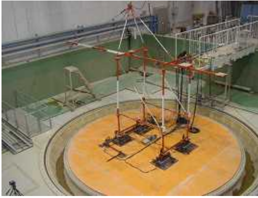
写真-1 クレーン模型および振動台全景
