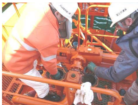
図-13 ストレーナの清掃
