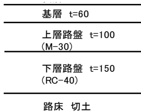
図-14(a) 舗装断面
