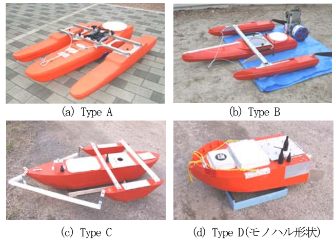
図-2 実験に用いた橋上操作艇
