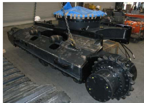
図－９ 工場組立の状況（走行フレーム）
