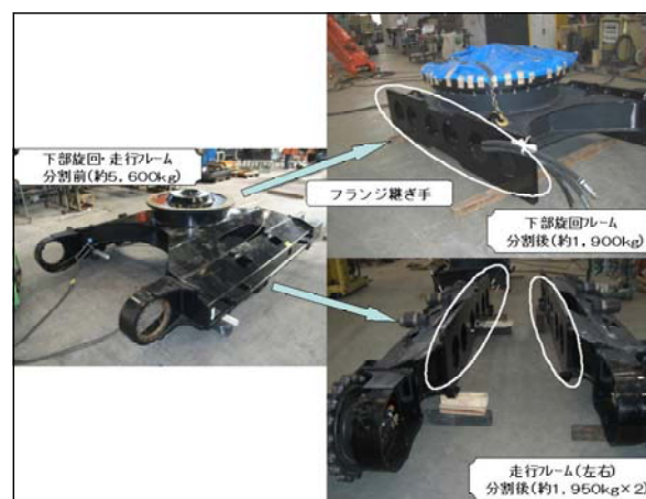
図－5 下部旋回・走行フレームの分割
