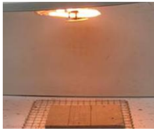
写真-6 ハロゲンヒーターによる再撥水化処理
