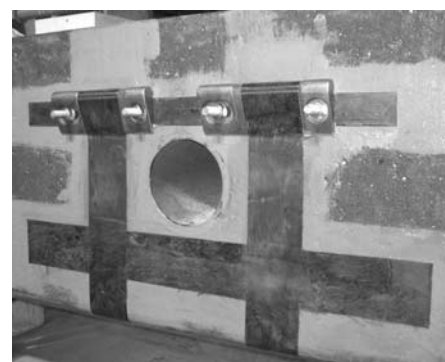
図9 梁のあと抜き貫通孔補強の方法
