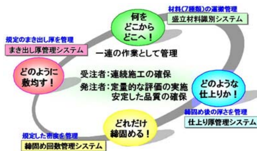
図-5-2-3 フィルダムで導入したICT技術 (中国地整)
