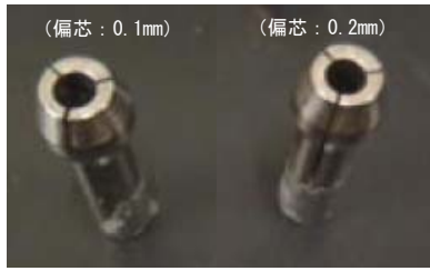
写真-2 試作した偏芯コレットの例
