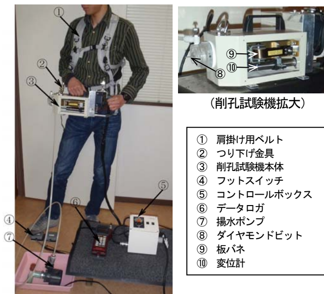
写真-1 削孔試験装置の構成
