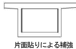
図 5-3 繊維シート接着工法案 写真 5-1 炭素繊維シートによる耐震補強の例
