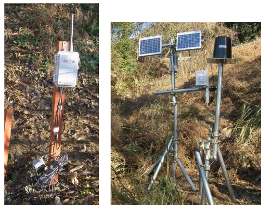
図-1 斜面の無線モニタリング（左下：子機、右下：親機）
