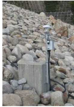
図-9 下流側測量用標的の設置構造
