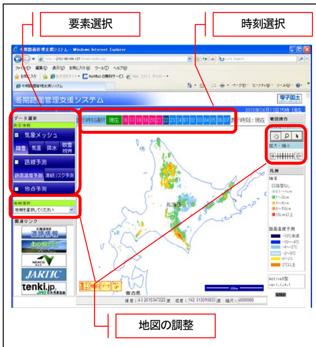
図-5 冬期路面管理支援システム
