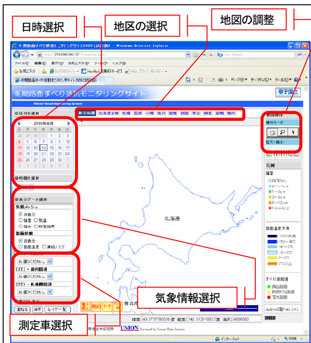
図-7 冬期路面すべり抵抗モニタリングシステム
