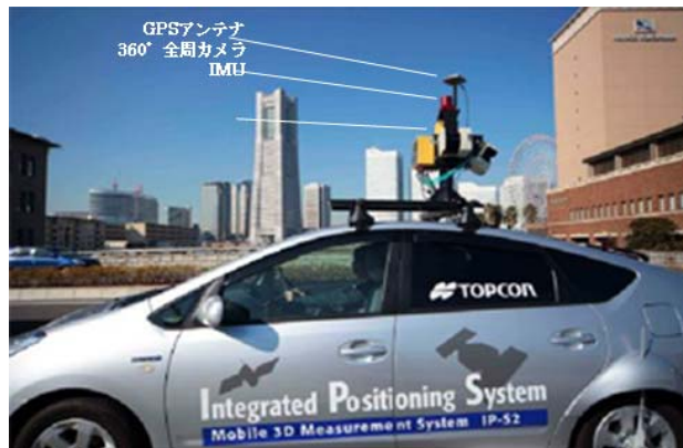
図-1 Mobile Mapping Systemの概観 (トプコン社HPから転載)
