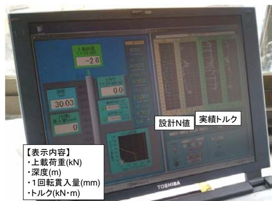
図-7 施工状況モニター
