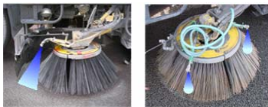
図-2 散水方式の比較
