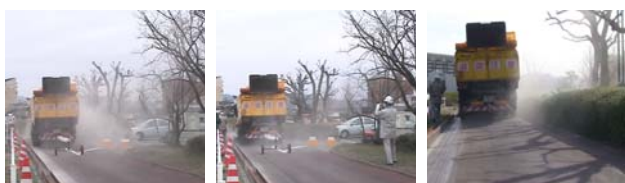
散水無し 側ブラシ部のみ散水 前ノズルのみ散水
