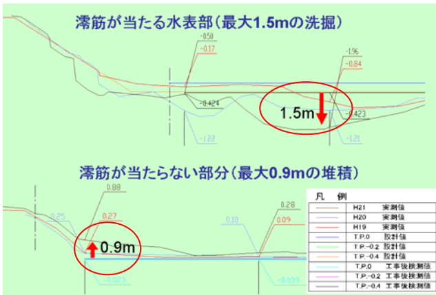
図-11 河岸湿地整備箇所の土砂堆積傾向
