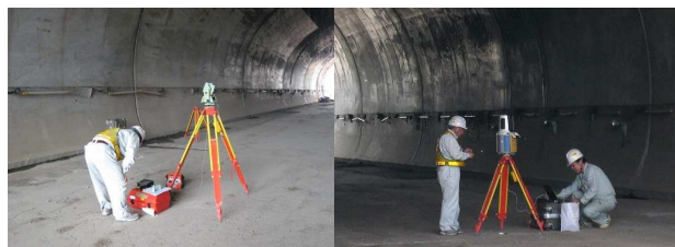
図-8 在来技術による出来形計測 (左：TS、右定置式3Dスキャナ)
